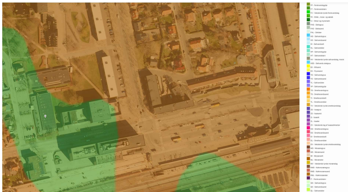
Figur 5. Jordartskort ved Banegårdspladsen. Viser overvejende moræneler, læg dog mærke til den grønne tunge på del af Sydvestvej der skal ombygges, som angiver ferskvandstørv.
